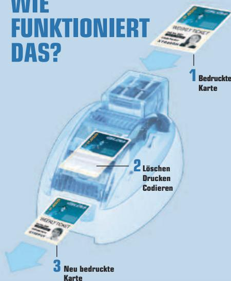
Der **Tattoo RW** arbeitet anstatt mit einem Druckband mit wiederbeschreibbaren Karten. Diese Karten enthalten ein wärmeempfindliches Material, das je nach angewandeter Temperatur sichtbar oder unsichtbar wird. Dieser umkehrbare Prozess erlaubt es, eine Karte bis zu 500 Mal immer wieder neu zu bedrucken. So können Sie auf Ihre Karten wechselnde Motive und Angaben aufdrucken, wie etwa Treuepunkte oder Sonderaktionen auf Kundenkarten, oder Namen von Besuchern auf Firmenkarten.
